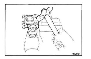
(d) Using SST, push out the bearing from the flange. SST 09332-25010
